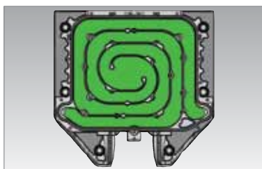
Sistema de arrefecimento fechado (CLCS)
