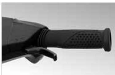
Alavanca de freio iBR™ (Freio e ré inteligentes)
